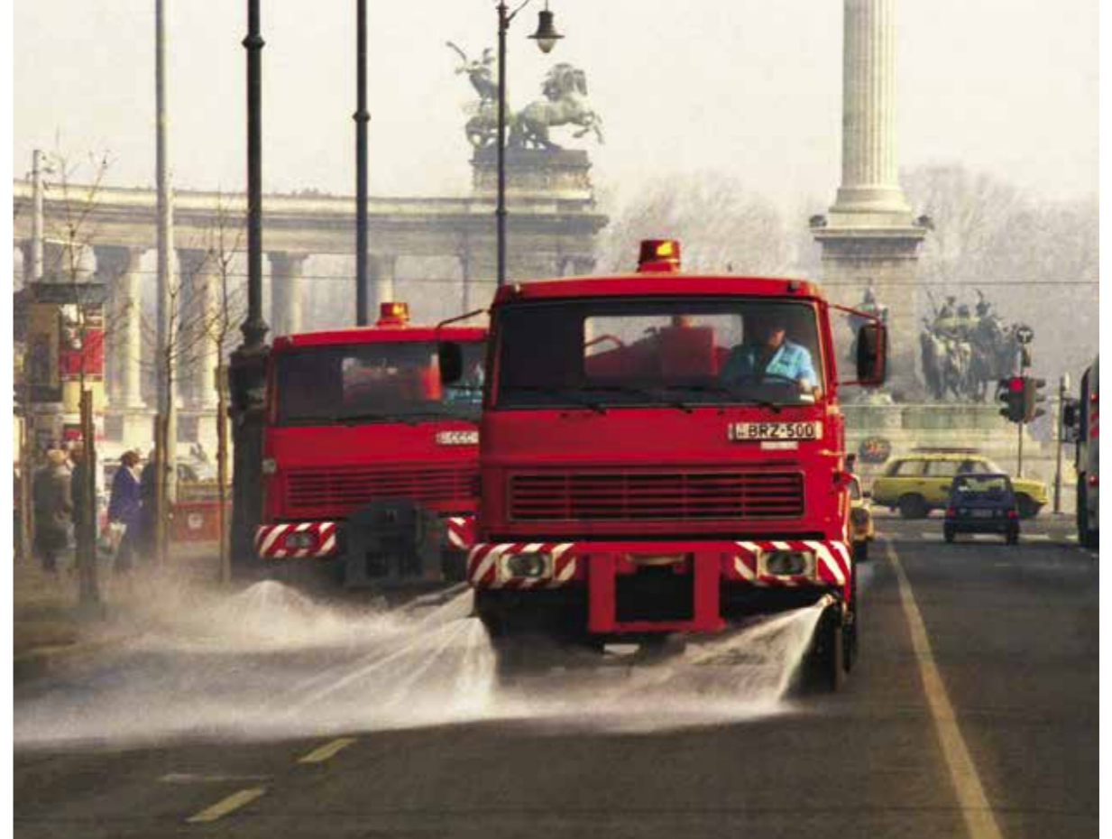
Az SA-8 típusú locsoló-mosó gépeket 1986-ban szerezte be a vállalat. LIAZ 110.850 alvázon Karosa SA-8 locsoló-mosó felépítmény.
