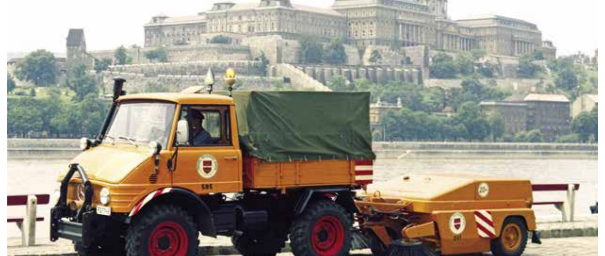
A Ries önfelszedő seprőgépeket az 1960-as években vásárolta a vállalat, meghajtását a vontató járműről kapta. A képen látható Mercedes Unimog téli-nyári célgépek 1963 óta vannak jelen a társaság flottájában.
