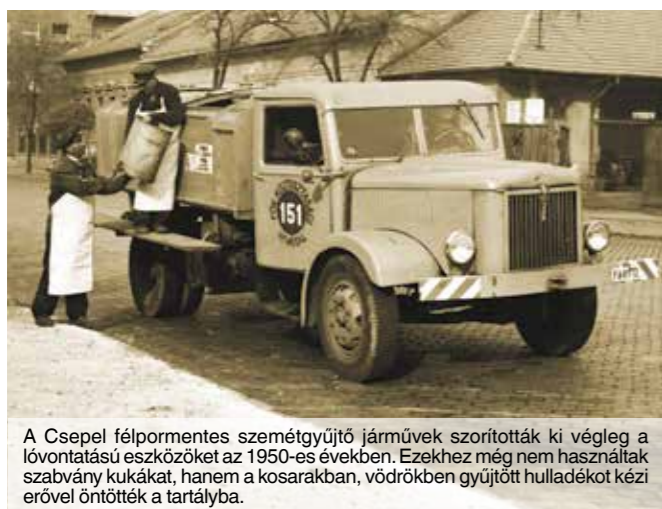
Az első pormentes hulladékgyűjtő jármű alváza a Mercedes-Benz, a tartály pedig az augsburgi Keller und Knappich gyárból került ki. A főváros csak az első járművet rendelte a KUKA (Keller Und Knappich Augsburg) cégtől, a következő már licenc alapján a Magyar Királyi Állami Vas-, Acél- és Gépgyárakban készült.
