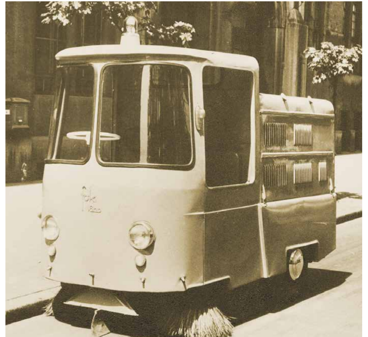
Az 1960-as években a Hivatal saját fejlesztéssel létrehozott egy kisteljesítményű önfelszedő seprőgépet, amelyet FOKI néven állítottak forgalomba. A gépet sorozatgyártásra szánták, de ez elmaradt.
