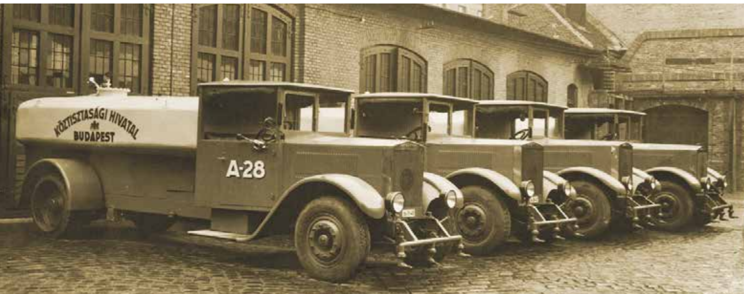
Az első nem szabadéssel dolgozó, 9000 literes víztartályú Krupp motoros locsológépkocsit az 1930-as években állította üzembe a Köztisztasági Hivatal. A győri Magyar Waggon- és Gépgyár Rt. 1927-ben vásárolta meg a Fried Krupp Gépgyár nehéz tehergépkocsi licencét. Forrás: National Archives, Washington, USA
