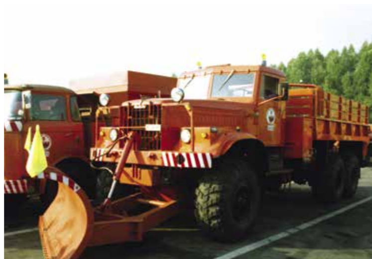
A Kraz összerakék-meghajtású terepjáró, teherszállító és vontató járművet 1987-ben vásárolta a vállalat a téli nagy havazások esetére.
