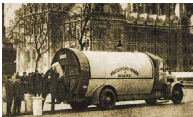
Az első pormentes hulladékgyűjtő jármű alváza a Mercedes-Benz, a tartály pedig az augsburgi Keller und Knappich gyárból került ki. A főváros csak az első járművet rendelte a KUKA (Keller Und Knappich Augsburg) cégtől, a következő már licenc alapján a Magyar Királyi Állami Vas-, Acél- és Gépgyárakban készült.
