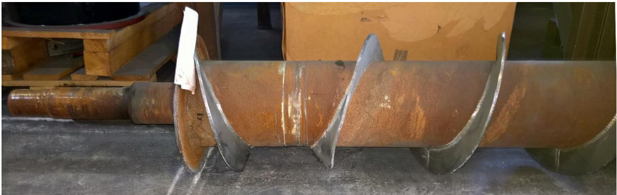
9. kép: a csiga hajtásoldali, ledobó surrantó felőli vége
