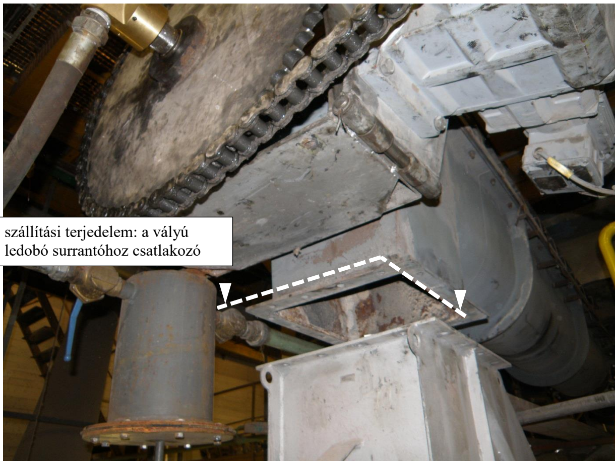
5. kép: a vályú hajtás felőli vége a ledobó surrantó csatlakozásnál a szállítási terjedelem jelölésével
