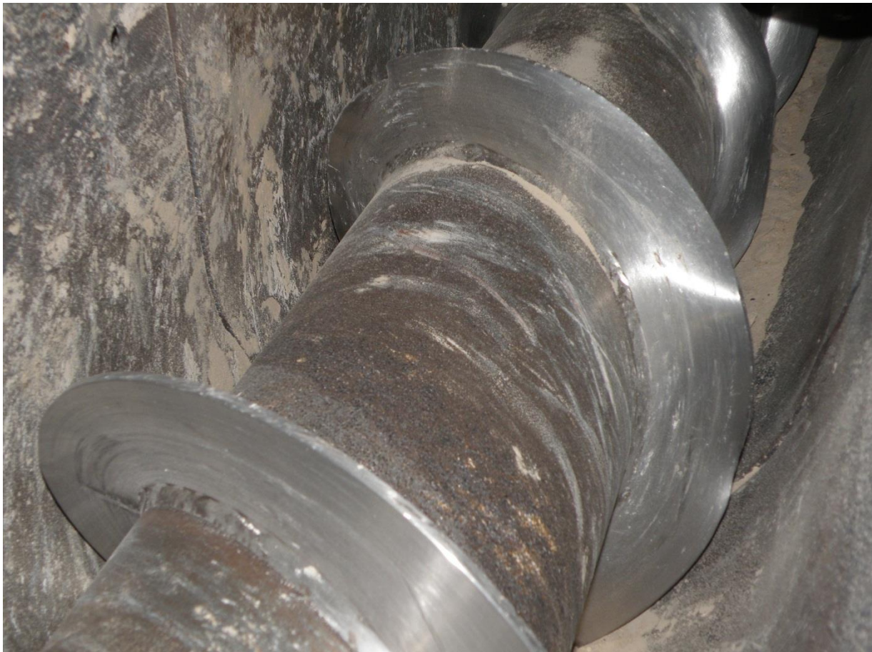
7. kép: a vályú két részének illesztése belülről a deformálódott csigával
